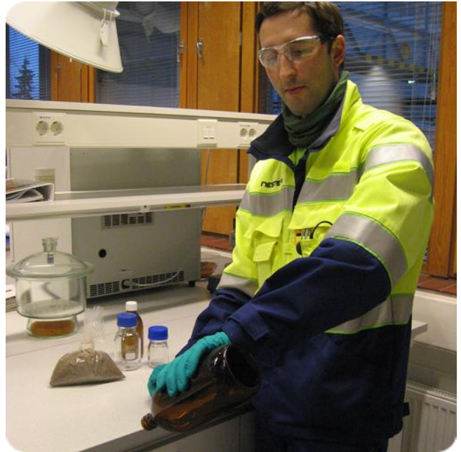
Ympäristöasiantuntija Juha Heijari näyttää, miten vesinäyte otetaan oikein. Näytettä ei kannata ottaa veden pinnalta imaisemalla, vaan hieman syvemmältä kauhaisemalla. Miljöexperten Juha Heijari visar hur ett vattenprov tas på korrekt sätt. Provet ska inte tas vid vattenytan utan man ska ta det lite djupare ned.
